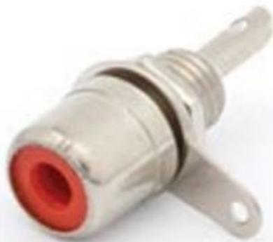
Presca RCA da pannello colore rosso, contatti a saldare e finitura nichelata. Foro pannello diametro 6 mm.
