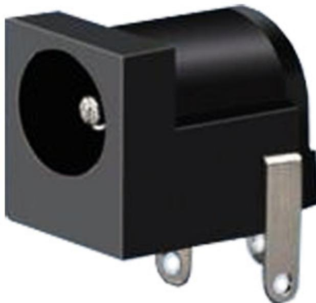
Presse di alimentazione da circuito stampato con terminali a saldare, dimensioni (mm): 5,5x2,1, corrente max. 0,5 A, tensione max. 50 volt.
