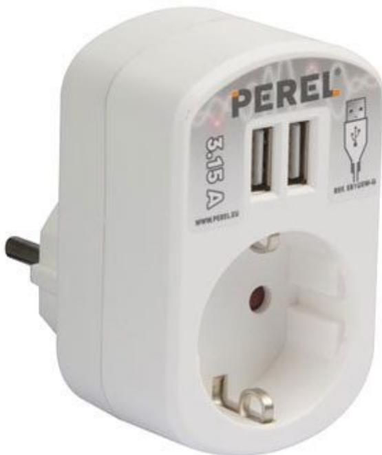
Presse di corrente passante con due prese USB da 5 V - 3,15 A (in totale). Colore: bianco, alimentazione: 230 Vac - 50 Hz, presa Schuko (tipo F): 16 A / 230 Vac - carico massimo 3680 watt, dimensioni (mm): 52x83x76, peso: 96 grammi.
