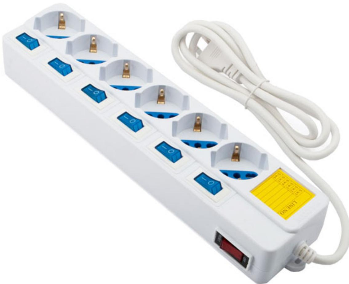
Presse multipla universale con 6 prese Schuko/bipasso (angolate di 45°), ognuna con interruttore luminoso e interruttore generale ON/OFF luminoso. Lunghezza del cavo 1,3 metri con spina italia (tipo L, CEI 23-16-VII), corrente massima 16 A, potenza massima 2.500 watt.
