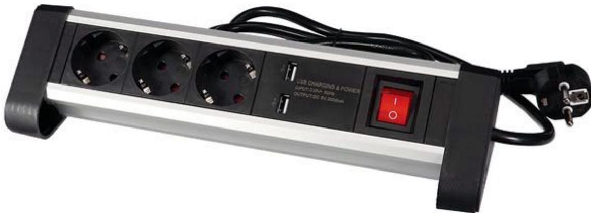
Adatta per il collegamento dei vari dispositivi presenti sulla scrivania di casa o laboratorio, questa multipresa è dotata di un robusto alloggiamento in alluminio con laterali plastici, 3 prese schuko (tipo F) con protezione per bambini, 2 uscite USB da 5VDC 2A e interruttore ON/OFF con segnalazione luminosa. per alimentare dispositivi.
