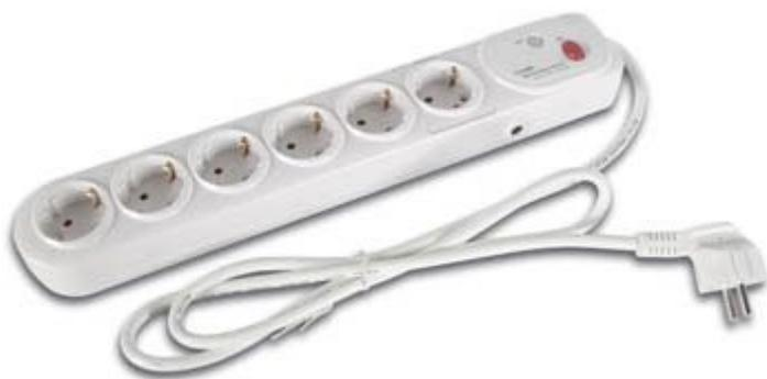
Ciabatta dotata di 6 prese SHUKO, tra cui una master e cinque slave. Quando il dispositivo collegato alla presa master viene spento, automaticamente tutti i dispositivi collegati alle prese slave vengono spenti.
