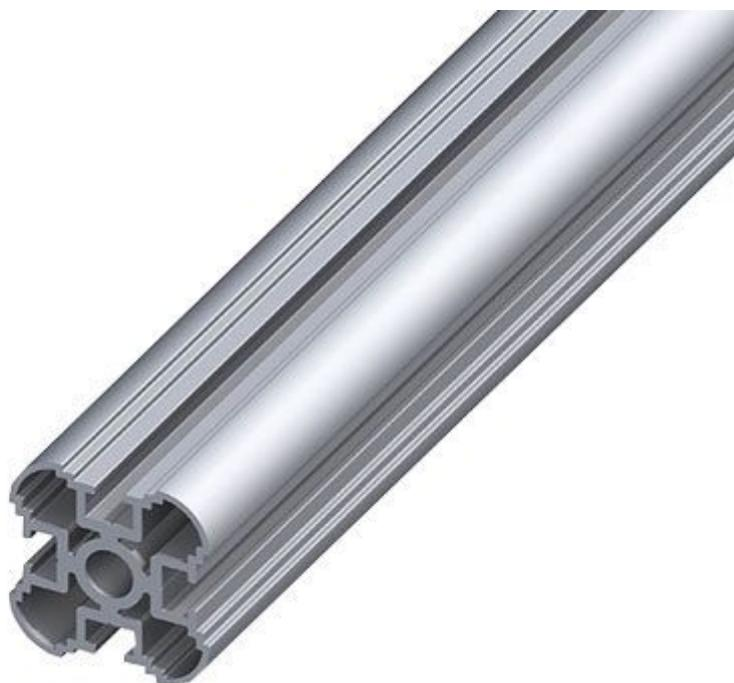
Particolarmente indicato per realizzare solide e leggere strutture meccaniche, questo profilato in alluminio dispone di quattro cavità scanalate coassiali che favoriscono il posizionamento preciso dei fori. Il foro è adatto a una filettatura M6 e serve allo stesso tempo come foro passante per M5. Dimensioni (mm): 27,5x27,5, lunghezza: 1 metro. Utilizzato per realizzare il telaio della stampante 3Drag.
