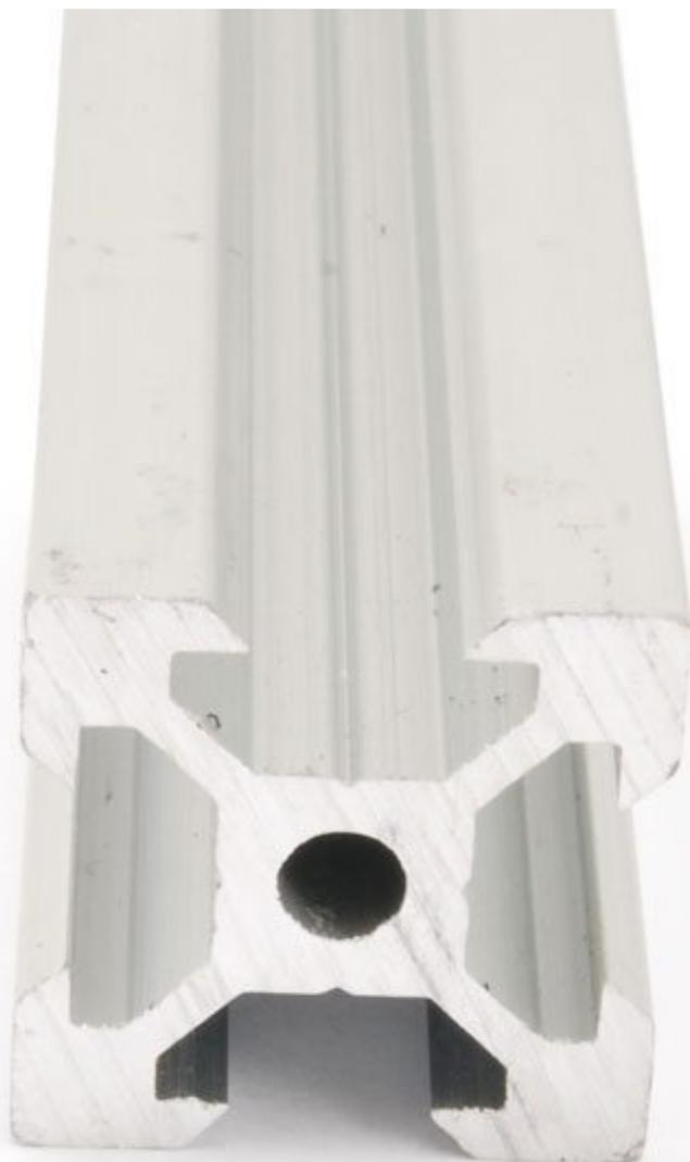
Profilato in estruso d'alluminio a sezione quadrata di alta qualità indicato per realizzare solide e leggere strutture meccaniche. Utilizzato per realizzare il telaio della stampante 3D4040 è estremamente modulare e consente svariate possibilità di montaggio. Inoltre dispone di quattro cavità scanalate coassiali tipo V-Slot che in abbinamento a pulegge OpenBuilds (a V, doppia V e mini) permettono di realizzare efficienti ed affidabili guide lineari per molteplici applicazioni
