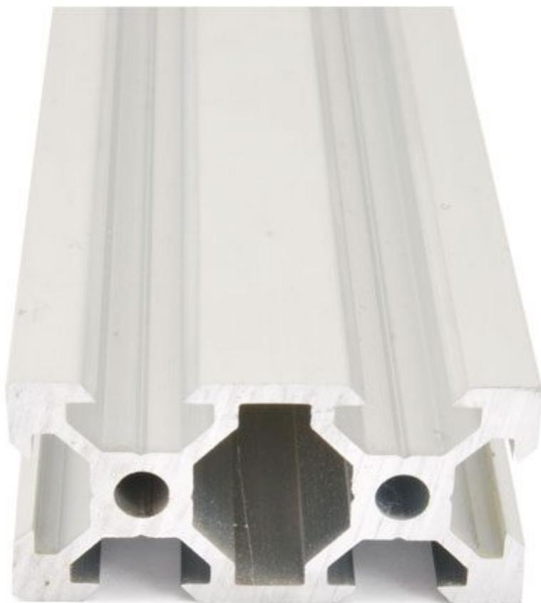
Profilato in estruso d'alluminio a sezione rettangolare, di alta qualità, indicato per realizzare solide e leggere strutture meccaniche. Utilizzato per realizzare il telaio della stampante 3D4040 è estremamente modulare e consente svariate possibilità di montaggio. Inoltre dispone di sei cavità scanalate tipo V-Slot che in abbinamento a pulegge OpenBuilds (a V, doppia V e mini) permettono
