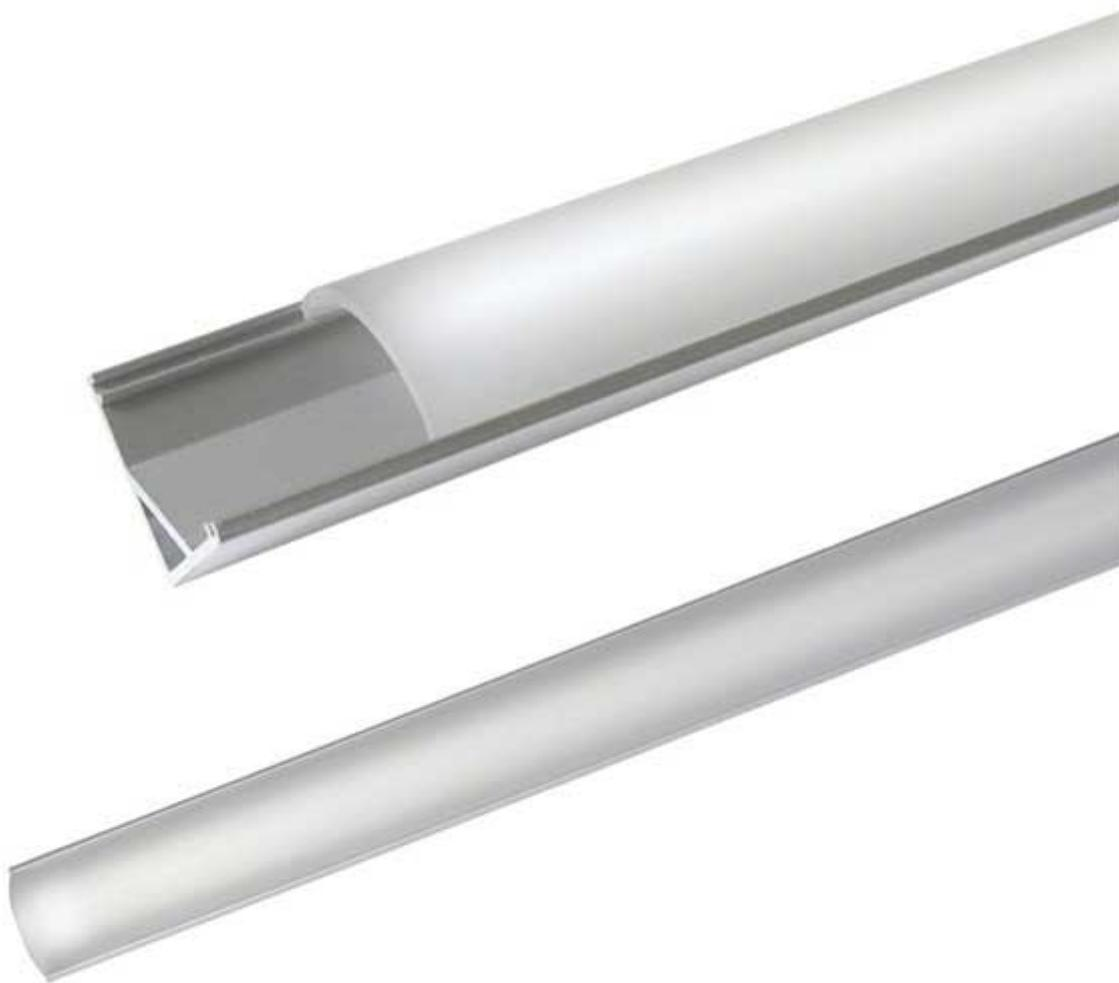
Questo profilo in alluminio è adatto per l'installazione di strisce a LED con larghezza max.11 mm (vedere prodotti correlati). La confezione include anche una copertura di plastica trasparente che diffonde l'85% della luce emessa dalla striscia a LED. Il profilo in alluminio oltre ad essere un elemento decorativo serve anche come dissipatore di calore. Dimensioni (mm): 16x16x1000. Particolarmente indicato per negozi, vetrine, uffici, ecc.
