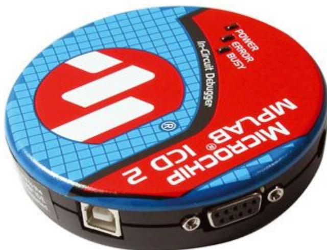
MPLAB ICD 2 è un programmatore in-circuit Microchip per dispositivi flash che consente anche il debugging del programma. Grazie al software fornito a corredo, il programma realizzato può essere eseguito in tempo reale, esaminato in dettaglio e debuggato. Il firmware interno può essere facilmente aggiornato dal sito Microchip.
