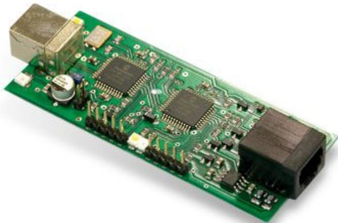
Versione hobbistica del programmatore ICD2 di casa Microchip. Permette di verificare il funzionamento del software in fase di sviluppo direttamente sulla scheda a microprocessore, operando congiuntamente all'ambiente IDE MPLAB. Comunica con il PC attraverso la porta USB, dalla quale riceve anche l'alimentazione. Può funzionare come programmatore ed è in grado di alimentare direttamente la scheda in fase di progetto e analisi.
