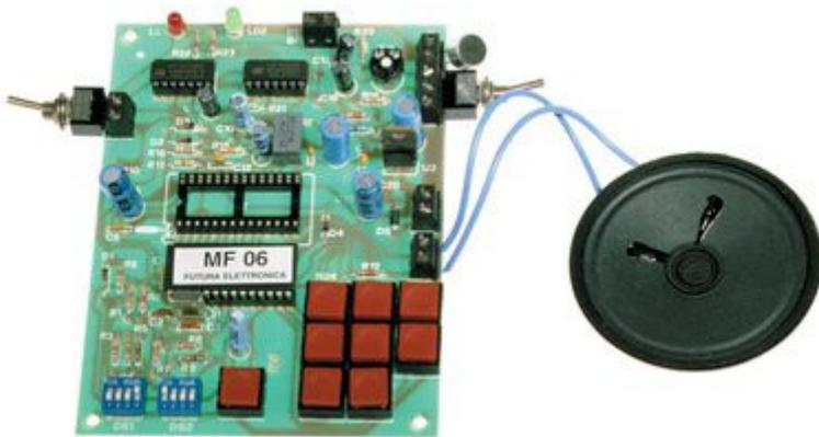
Programmatore universale per integrati DAST della serie ISD 2000 con possibilità di programmare 1/2/4/8 messaggi su ciascun chip e con possibilità di riascolto. Il dispositivo utilizza un microcontrollore per la gestione di tutte le funzioni.
