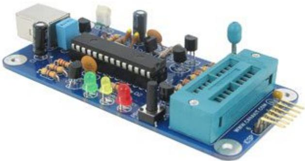
Programmatore USB per microcontrollori PIC Microchip completo di zoccolo ZIF (Zero Insertion Force) a 20 pin. Compatibile al 100% con il modello PICKIT2 originale Microchip, con il vantaggio di potere programmare direttamente su texttool i pic fino a 18 pin e tutti gli altri modelli tramite In-Circuit. E' possibile aggiornare gratuitamente il programmatore sfruttando il firmware fornito da Microchip.
