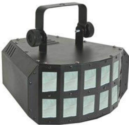
Proiettore a LED (3 x 3 watt) bianchi effetto Derby. Dispone di controllo DMX a 2 canali; funziona in modalità stand-alone, master/slave o controllo musicale. Velocità di rotazione regolabile via DMX. Avvia in modalità automatica in assenza di segnale DMX.
