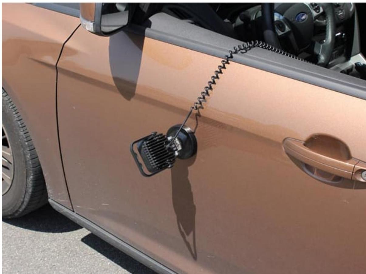
Proiettore con lampada costituita da 5 LED Bridgelux da 3 watt con luce bianco neutro. Dotato di staffa di montaggio in acciaio inox, base magnetica, maniglia, plug per presa accendisigari, flusso luminoso: 800 lumen, temperatura colore: 7500K, angolo di emissione: 120°, alimentazione: da 11 a 30 Vdc.
