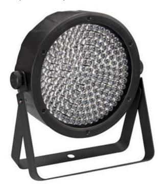
Compatto e originale proiettore PAR64 dotato di 180 LED (39 rossi, 39 verdi, 51 blu, 51 ambra) ad alta intensità luminosa. Grazie alla batteria ricaricabile integrata, può funzionare senza rete elettrica fino ad una massimo di 20 ore. Può funzionare in modalità automatica, a controllo musicale, tramite DMX, master/slave o semplicemente con il telecomando IR in dotazione. La confezione comprende il proiettore, il telecomando IR e il cavo di alimentazione.
