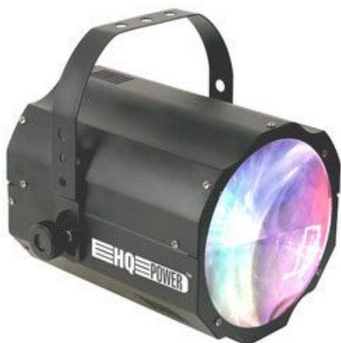
Potente proiettore moonflower dotato di 256 LED RGB+bianco (64 per colore). Modalità di funzionamento: tramite DMX (8 canali), automatica, master/slave o attivazione musicale tramite microfono incorporato (sensibilità regolabile). Ogni LED può essere controllato singolarmente. Dimensioni: 305 x 275 x 280 mm. Ideale per piccoli palchi, discoteche, teatri, ecc.
