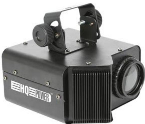
Proiettore moonflower dotato di LED Cree da 10 watt, effetti preimpostati per il funzionamento in modalità stand-alone, controllo master/slave o DMX 3 canali (dimmer, strobo e velocità di rotazione) e messa a fuoco manuale. Alimentazione 240 Vac, dimensioni 230 x 200 x 150 mm.
