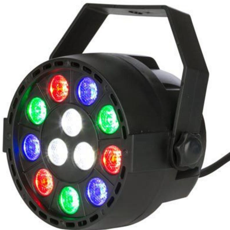
Compatto proiettore PAR con corpo in ABS e staffa. Dispone di 12 LED da 1 watt (3 rossi, 3 verdi, 3 blu e 3 bianchi) molto luminosi e in grado di fornire un'intensità di colore eccellente. Può essere controllato in modalità DMX a 8 canali (macro, colore, velocità, oscuramento, rosso, verde, blu, bianco), master/slave e stand-alone.
