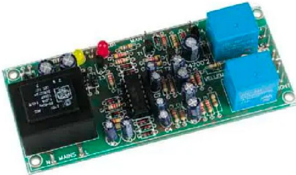
Questa protezione stereo per altoparlanti elimina i tipici "click", ricorrenti all'atto dell'accensione, nonché le componenti continue sull'uscita dell'amplificatore collegato.
