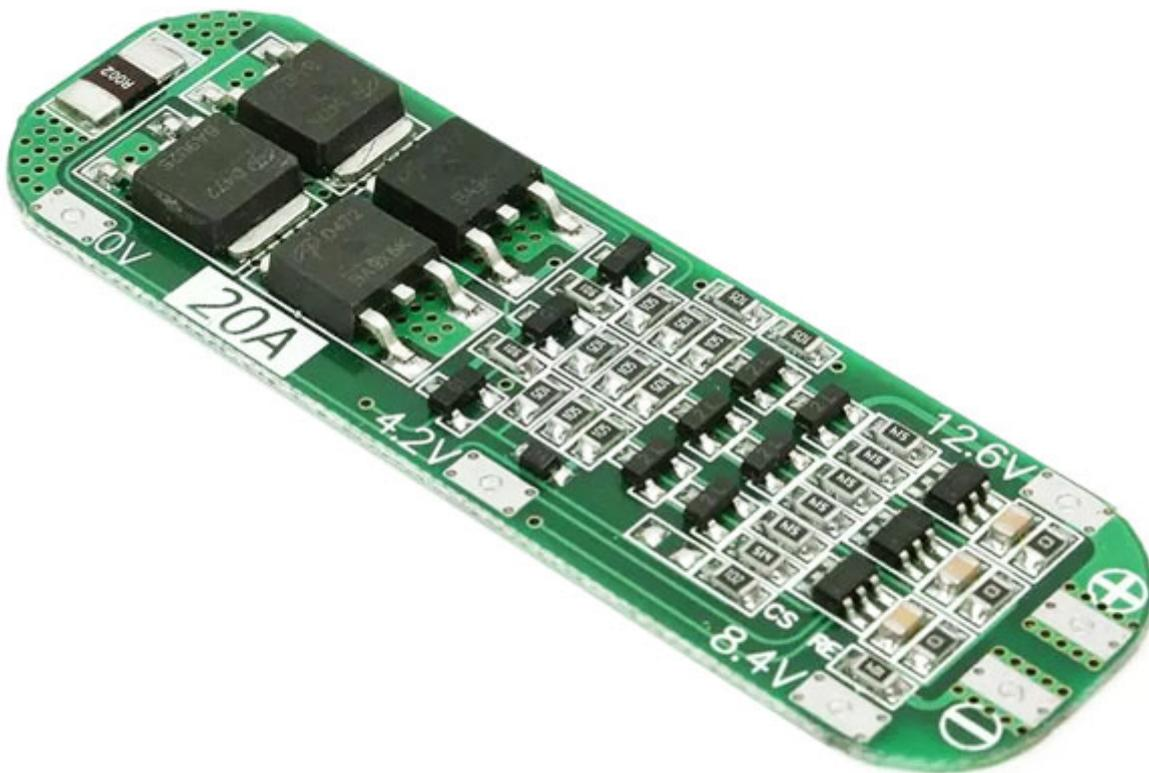
Modulo BMS (Battery Management System) per pacchi batteria costituiti da 3 batterie agli ioni di litio da 3,7 volt (18500, 18650, ecc). Consente di bilanciare la carica e proteggere il pacco batteria da eccessiva carica e scarica.
