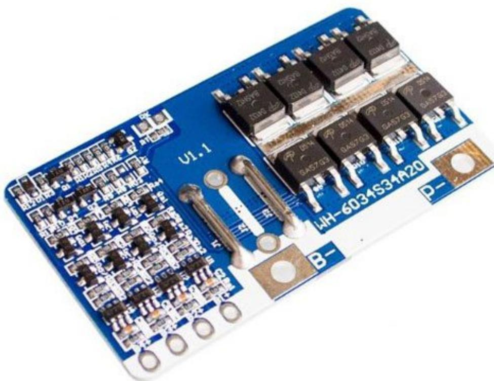
Protezione per pacchi batteria Li-ion e Li-Po da 14,4 volt (3,6 volt x 4S), 14,8 volt (3,7 volt x 4S) e 16,8 volt (4,2 volt x 4S).
