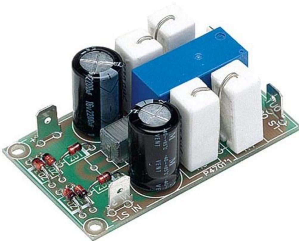
Montato all'interno della cassa acustica, il dispositivo provvede a isolare l'altoparlante non appena viene rilevata la presenza di tensione continua. Ideale anche per l'uso in auto.
