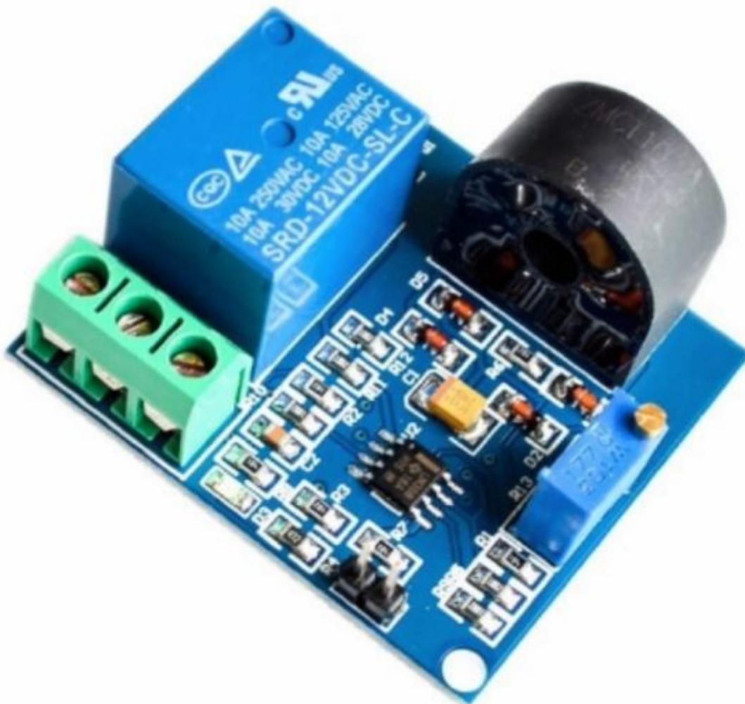
Modulo in grado di leggere e determinare un allarme in caso di superamento di una soglia di corrente. La lettura avviene in un cavo di rete AC passante e l'attivazione del relè tramite una soglia impostabile, fino a 5 A. L'uscita a relè ha i contatti "puliti", e possono essere utilizzati per staccare il carico all'arrivo del sovraccarico o attivare un segnalatore luminoso o acustico.
