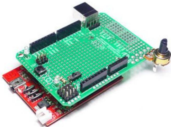
Piastra sperimentale (58,50 x 82,70 mm) per piccole applicazioni, realizzata appositamente per le schede Arduino o Seeeduino, permette di avere un numero maggiore di piazzole su cui montare i componenti. Alcuni piazzole sono predisposte per montare un connettore USB tipo B, un mini potenziometro da stampato, pulsanti, LED, ecc. Dispone di piazzole riservate al montaggio di connettori per UART, ISP e I2C.
