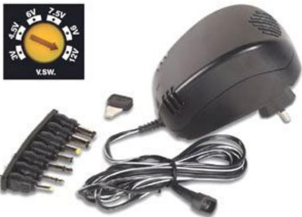
Alimentatore universale 300 mA non stabilizzato. Potenza: 3,6 VA. Tensioni d'uscita selezionabili: 3 - 4,5 - 6 - 7,5 - 9 - 12 Vdc. Completo di 7 connettori a plug intercambiabili. Spina di tipo SHUKO.
