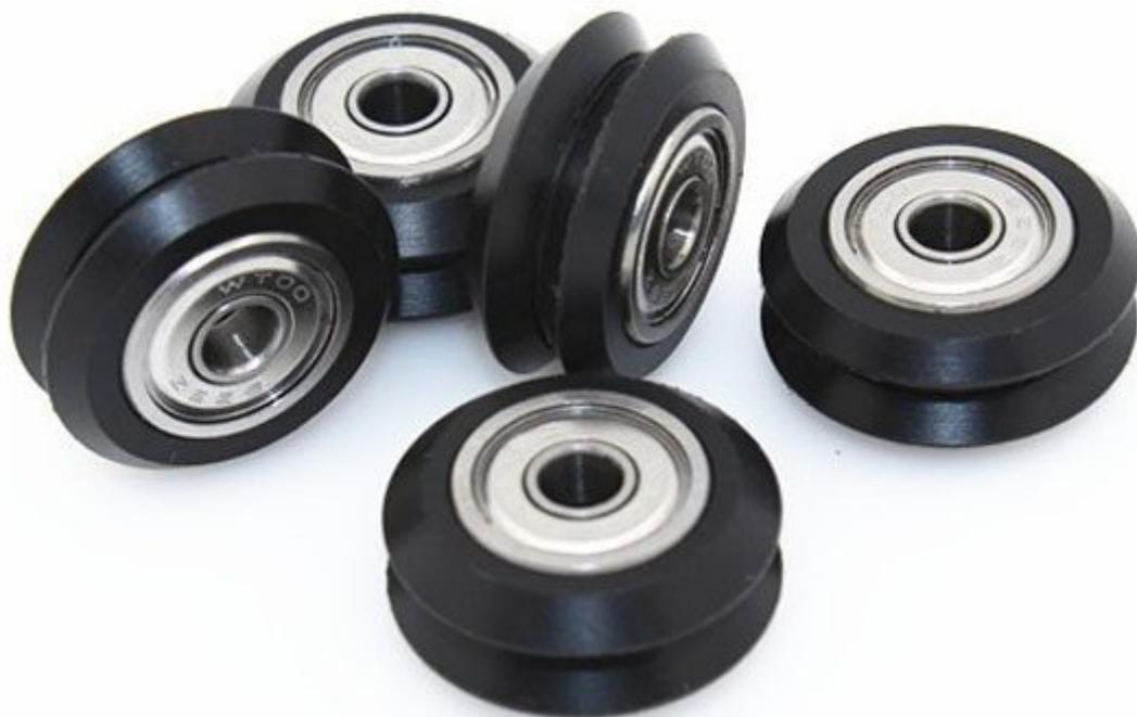
Puleggia a doppia V in Delrin (Poliossimetilene), resistente alla flessione e molto solida. Abbinata a profili in alluminio tipo V-Slot permette di realizzare ottime guide lineari in una grande varietà di progetti (stampanti 3D, CNC, plotter, ecc). Completa di 2 cuscinetti 625ZZ con foro centrale da 5 mm.
