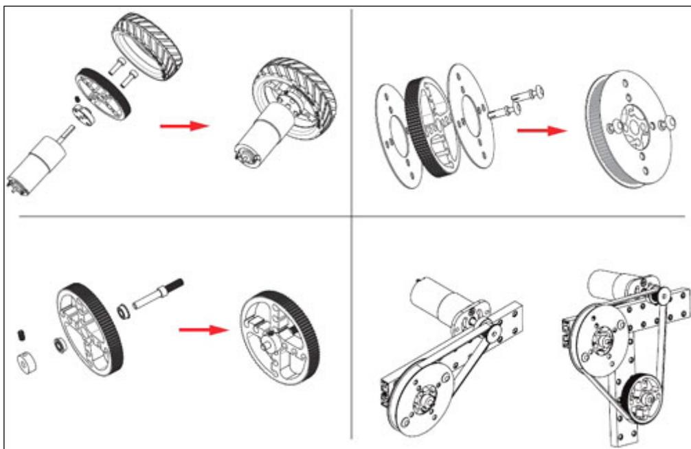
Confezione contenente 4 pulegge dentate in alluminio anodizzato blu 6061. Abbinare a cinghie dentate MXL, oppure utilizzate come semplici ingranaggi, permettono di creare movimentazione di oggetti. Possono essere abbinare ai cingoli 6132-87050 per realizzare robot cingolati, oppure possono essere utilizzate come semplici ruote per robot. Diametro esterno circa 38 mm, spessore 8 mm.
