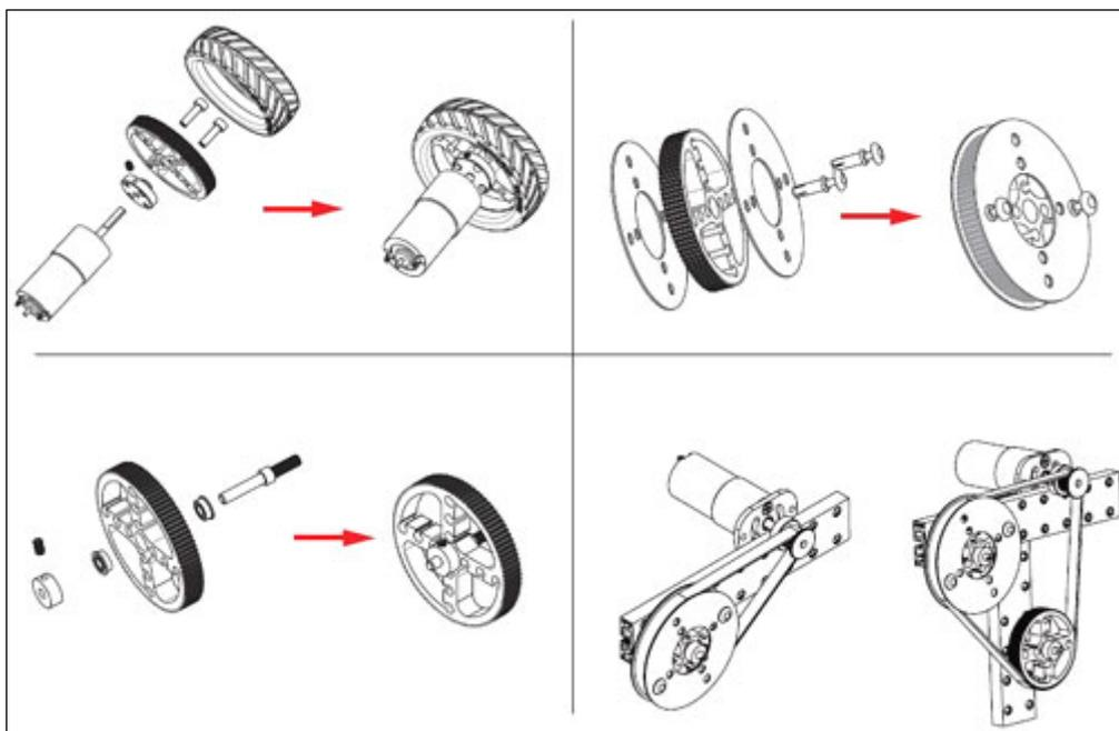
Confezione contenente 4 pulegge dentate in alluminio anodizzato blu 6061. Abbinare a cinghie dentate MXL, oppure utilizzate come semplici ingranaggi, permettono di creare movimentazione di oggetti. Possono essere abbinare ai cingoli 6132-87050 per realizzare robot cingolati, oppure possono essere utilizzate come semplici ruote per robot. Diametro esterno circa 58 mm, spessore 8 mm.
