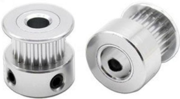
Puleggia dentata tipo GT2 a 20 denti con passo 2 mm. Realizzata interamente in alluminio dispone di foro centrale da 5 mm ed è idonea per l'utilizzo con cinghie dentate GT2 da 6 mm di larghezza. Fissaggio mediante 2 grani M4 (inclusi) posizionati a 90° l'uno dall'altro. Ideale per l'utilizzo in sistemi di automazione quali stampanti 3D e CNC.
