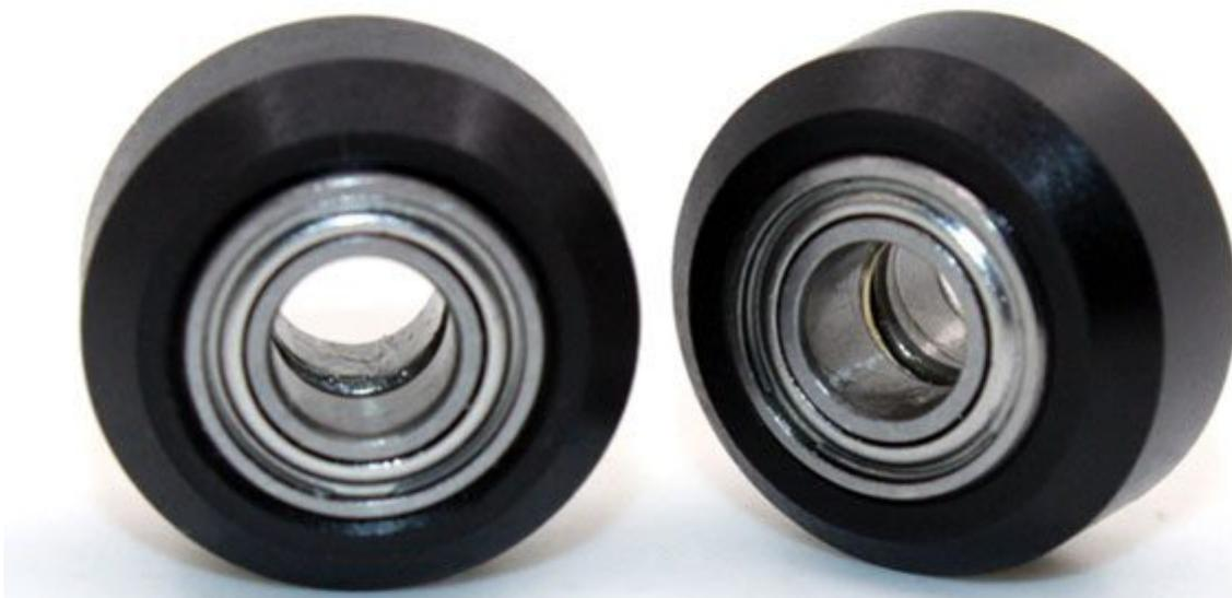
Puleggia a V in Delrin (Poliossimetilene), resistente alla flessione e molto solida. Abbinata a profili in alluminio tipo V-Slot permette di realizzare ottime guide lineari in una grande varietà di progetti (stampanti 3D, CNC, plotter, ecc). Completa di 2 cuscinetti 625ZZ con foro centrale da 5 mm. Dimensioni (mm): diametro 24x10,2.
