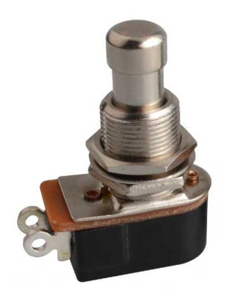
Pulsante in metallo da pannello estremamente robusto, viene solitamente utilizzato nella costruzione di effetti per chitarra, pulsanti a pedale, ecc. Specifiche tecniche: tipo: off-(on) SPST, massima tensione contatti: 3 A / 250 VAC (6 A/ 125 VAC), contatti tipo: OFF-(ON).
