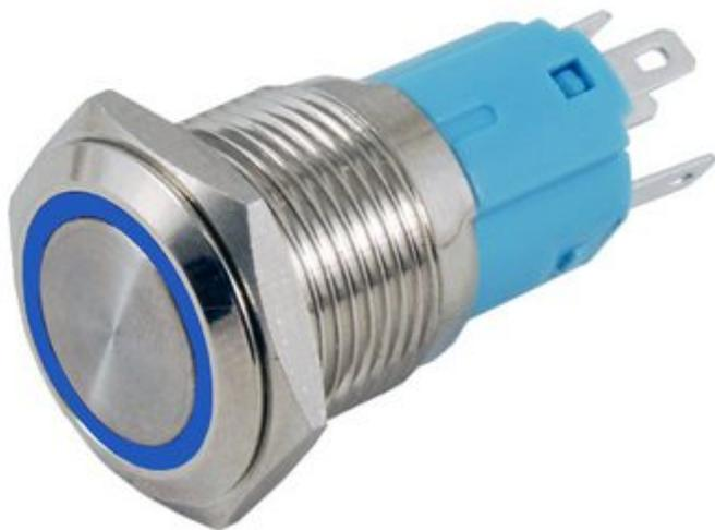
Pulsante antivandalo in metallo di tipo OFF/(ON) con contatti NC/NO/C (normalmente aperto / chiuso e contatti: 36 VDC / 2 A, temperatura di funzionamento: da -20°C ~ +55°C, umidità: 45 ~ 85% RH, resistenza ottone nichelato, foro di fissaggio: Ø 16 mm, grado di protezione: IP65 / IK8 (livello di resistenza agli urti n
