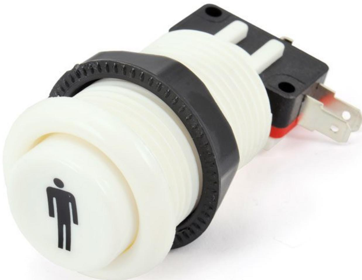
Pulsante bianco con simbolo 1 giocatore. Dispone di microswitch a 3 terminali (comune, normalmente aperto e normalmente chiuso) in grado di sopportare 3 A a 125 Vac. Lunghezza totale: 65 mm, diametro ghiera di fissaggio: 35 mm, diametro foro di fissaggio: 28 mm, colore: verde, peso: 25 grammi.
