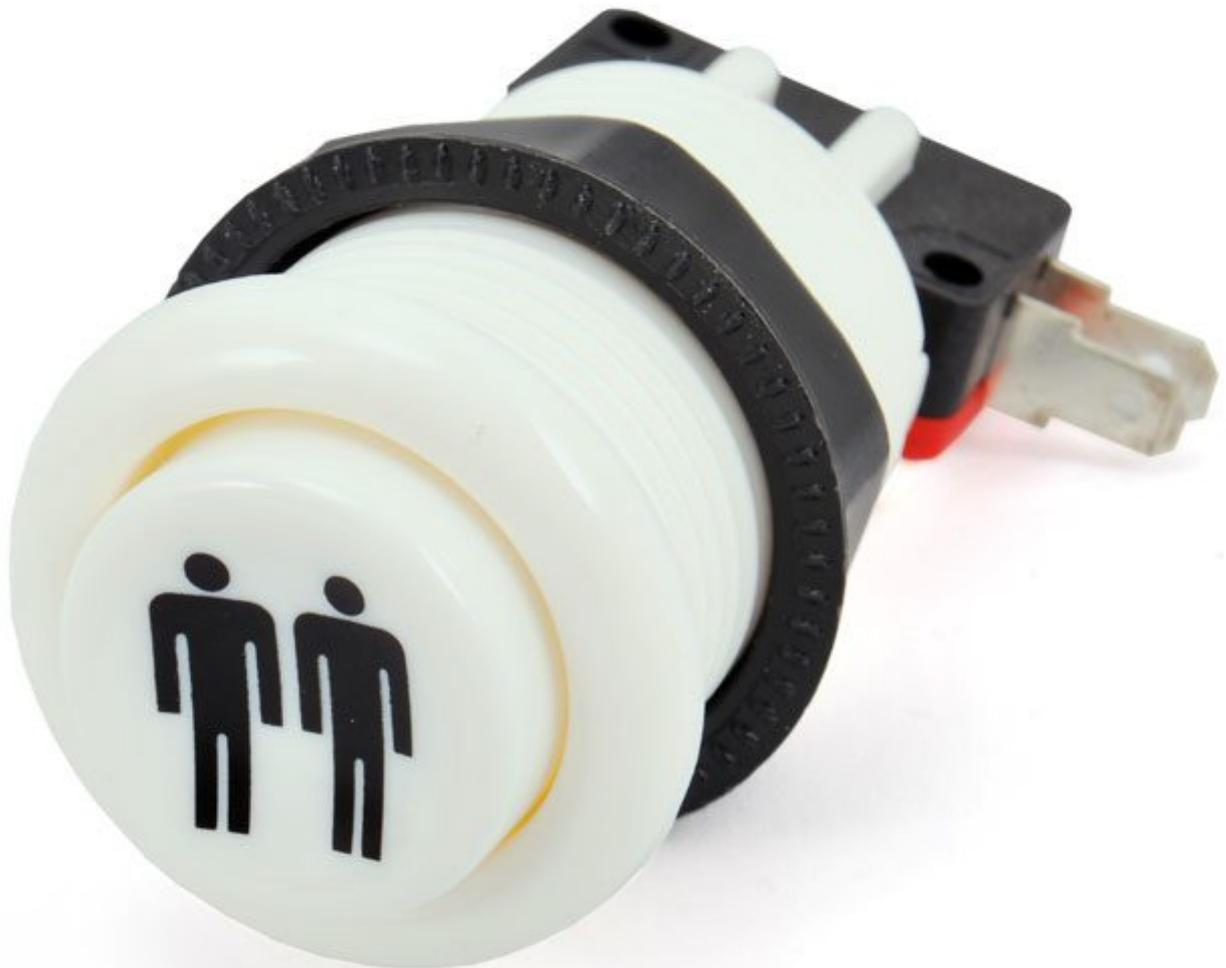
Pulsante bianco con simbolo 2 giocatori. Dispone di microswitch a 3 terminali (comune, normalmente aperto e normalmente chiuso) in grado di sopportare 3 A a 125 Vac. Lunghezza totale: 65 mm, diametro ghiera di fissaggio: 35 mm, diametro foro di fissaggio: 28 mm, colore: verde, peso: 25 grammi.
