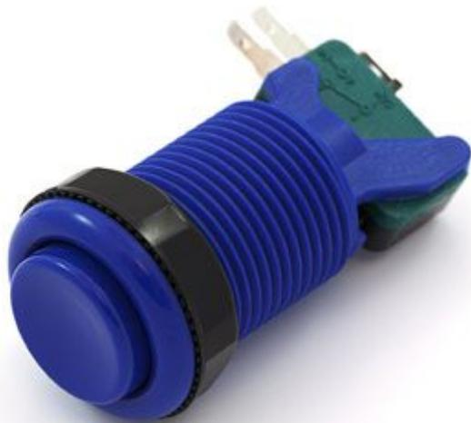
Molto simile ai pulsanti utilizzati nei giochi arcade, dispone di microswitch a 3 terminali (comune, normalmente aperto e normalmente chiuso) in grado di sopportare 3 A a 125 Vac. Lunghezza totale: 65 mm, diametro ghiera di fissaggio: 35 mm, diametro foro di fissaggio: 28 mm, colore: blu, peso: 25 grammi.
