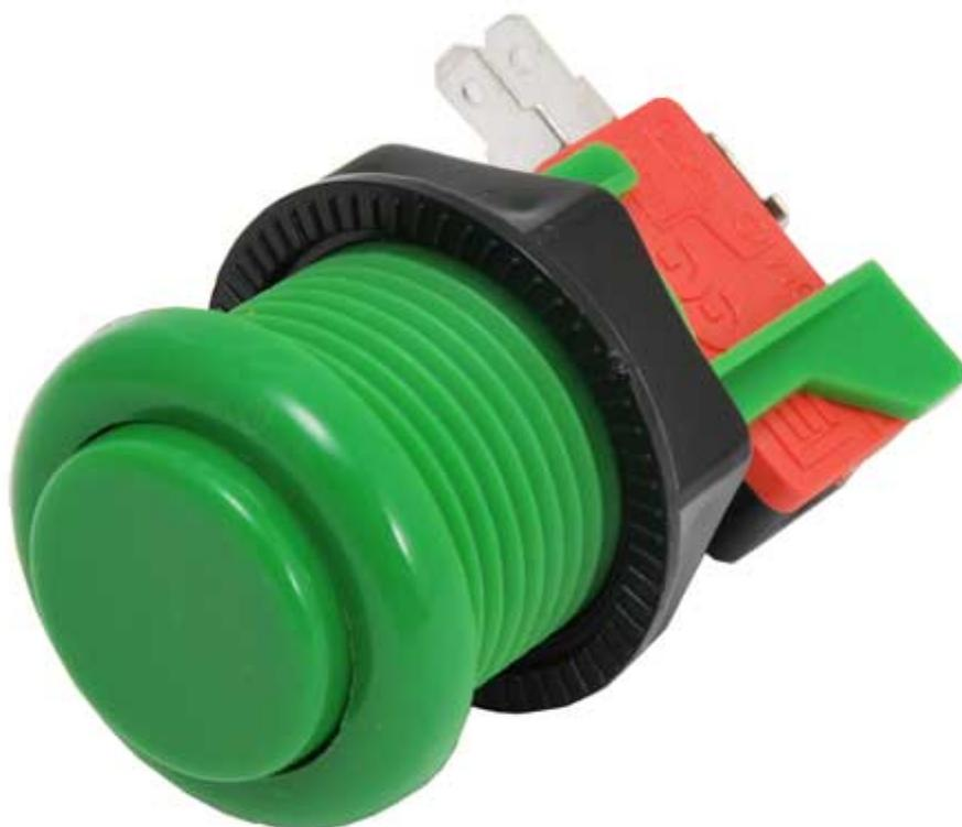
Molto simile ai pulsanti utilizzati nei giochi arcade, dispone di microswitch a 3 terminali (comune, normalmente aperto e normalmente chiuso) in grado di sopportare 3 A a 125 Vac. Lunghezza totale: 60 mm, diametro ghiera di fissaggio: 35 mm, diametro foro di fissaggio: 26,8 mm, colore: verde, peso: 17 grammi.
