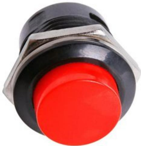
Pulsante da pannello. Colore: rosso, tipo di contatto: normalmente aperto, max. corrente: 3 A - 250 VAC, resistenza di contatto: 50 Mohm, resistenza di isolamento: 100 Mohm, temperatura di lavoro: da -25°C a +55°C. Dimensioni massime (mm): 25x16, diametro foro di fissaggio: 16 mm, terminali a saldare, peso: 5 grammi.
