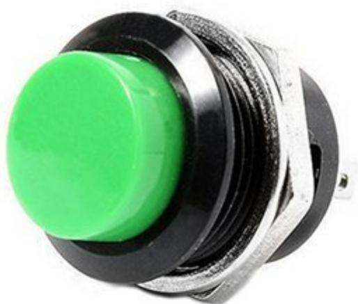
Pulsante da pannello. Colore: verde, tipo di contatto: normalmente aperto, max. corrente: 3 A - 250 VAC, resistenza di contatto: 50 Mohm, resistenza di isolamento: 100 Mohm, temperatura di lavoro: da -25°C a +55°C. Dimensioni massime (mm): 25x16, diametro foro di fissaggio: 16 mm, terminali a saldare, peso: 5 grammi.
