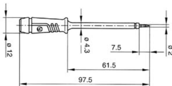
Puntale di test nero con presa posteriore da 4 mm, manico isolante e infrangibile, sottile punta in acciaio inossidabile.
