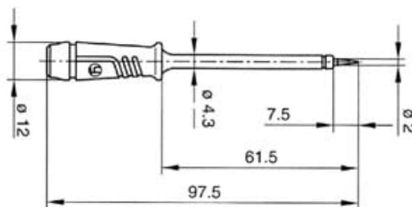
Puntale di test rosso con presa posteriore da 4 mm, manico isolante e infrangibile, sottile punta in acciaio inossidabile.
