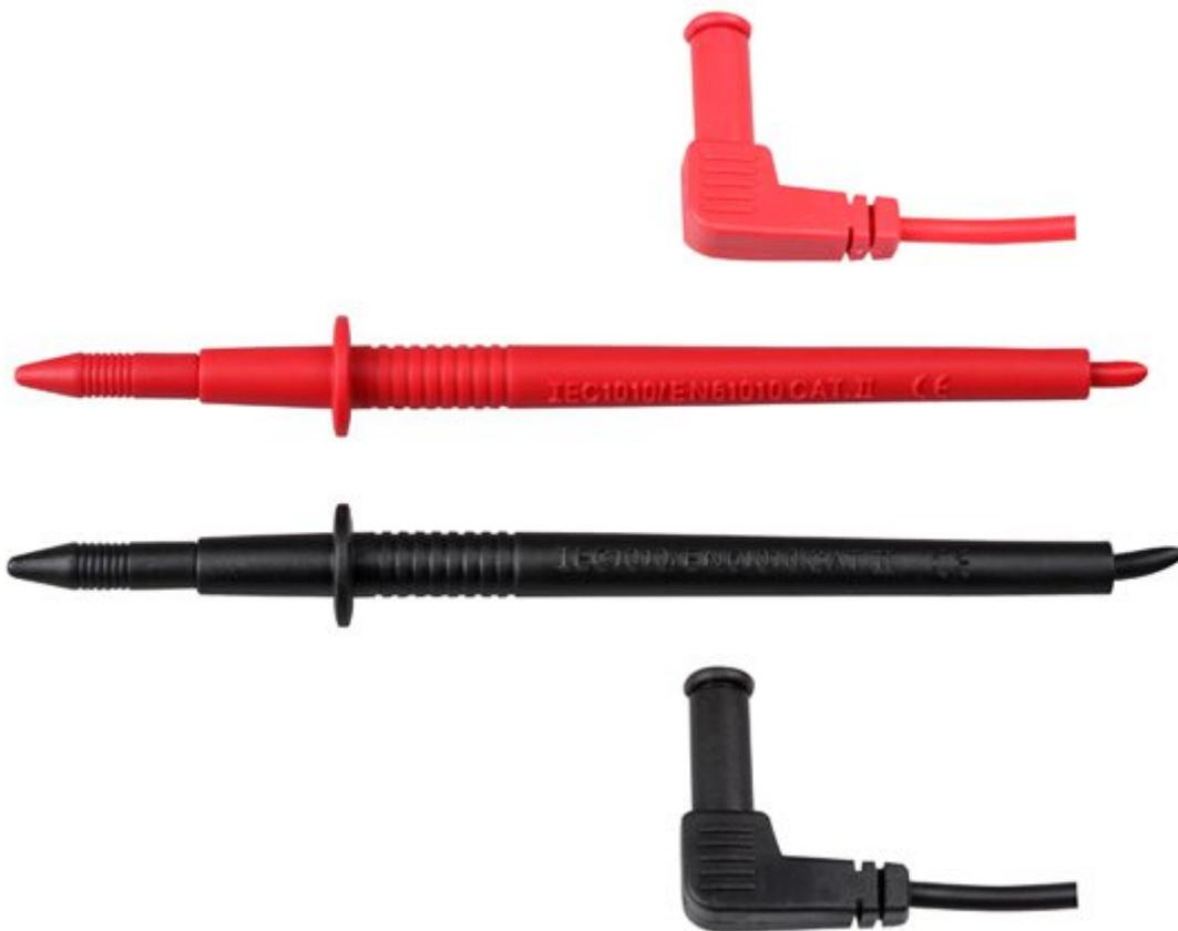
Indicati per tester CAT II (1000V-10A), questi puntali sono realizzati in acciaio e sono dotati di doppio isolamento in PVC e tappi di protezione. Diametro sonde di test e spine ad angolo retto: 2 mm, lunghezza cavo puntali: 75 cm. Attenzione! non utilizzare al di sopra dei valori massimi indicati.
