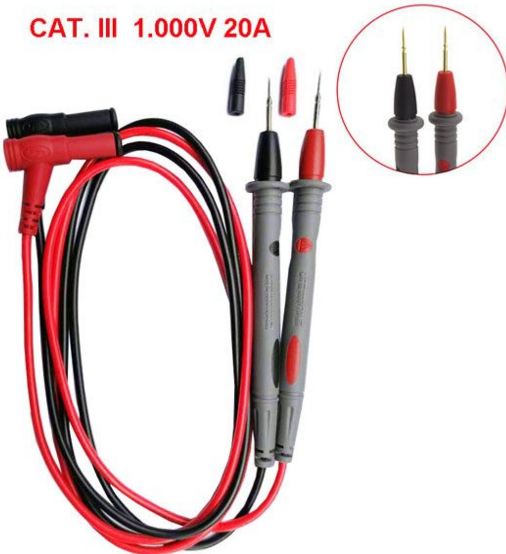
Puntali per multimetro con punte a spillo dorate, spina a banana da 4 mm, CAT III 1.000V 20A e cappucci protettivi. La lunghezza delle punte è di circa 22 mm con un diametro di 0,6 mm, lunghezza dei cavi è di circa 85 cm.
