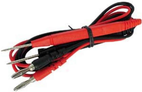
Puntali per tester con spina a banana da 4 mm. Lunghezza 1 metro, tensione massima 30V, corrente massima 2A. Attenzione! non utilizzare i puntali con valori al di sopra di quelli indicati. Lunghezza impugnatura: 60 mm
