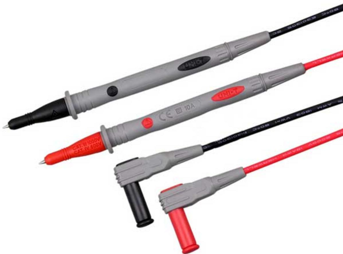
Puntali professionali per tester con spina a banana da 4 mm, cappucci plastici di protezione, cavo 18AWG. Portata 10 A / CAT III 1000V, 10 A / CAT IV 600V. Attenzione! non utilizzare i puntali con valori al di sopra di quelli indicati. Certificato di sicurezza: EN 61010-031 A1:2008.
