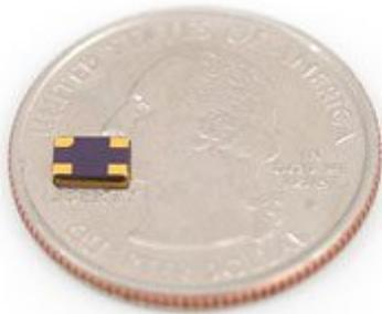
Quarzo da 12.288 MHz in SMD. Ideale per essere utilizzato con il chip VS1053B.
