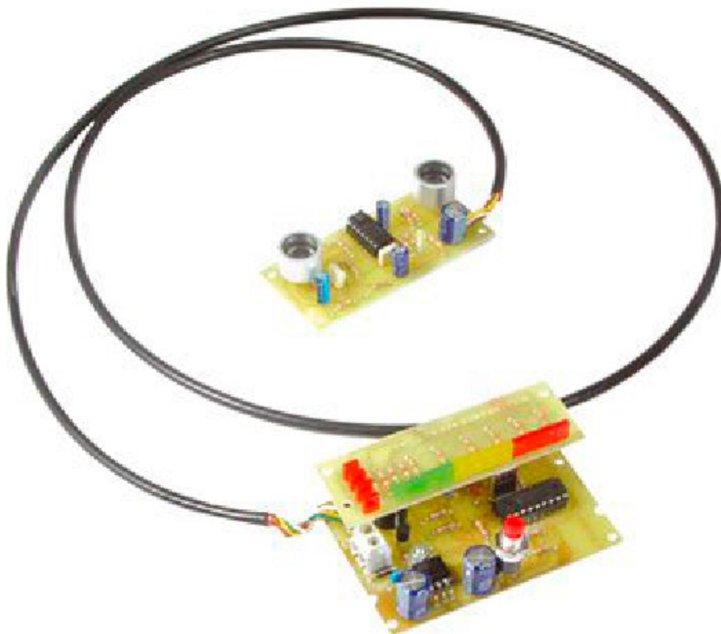
Grazie a due sensori ad ultrasuoni è in grado di segnalare, entro un range di 1,5 metri, a quale distanza si trova un oggetto; è possibile impostare una soglia al di sotto della quale un buzzer emette un segnale di allarme. Può essere utilizzato come "sensore di parcheggio" con cui equipaggiare un autoveicolo. Il kit viene fornito con visualizzatore a barra di led mentre è disponibile separatamente il display LCD 16 x 2 (CDL4162).
