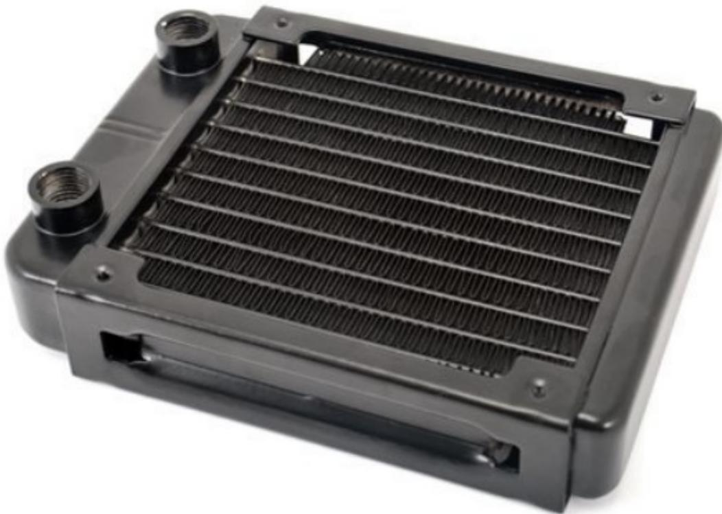
Radiatore ad acqua da utilizzare in abbinamento ad una ventola di raffreddamento 120x120 mm. Attacchi per tubo in gomma con diametro interno da 8 mm. Dimensioni massime (mm): 155,50x120,50x32,50. Distanza fori di fissaggio per la ventola: 104 mm, interasse raccordi tubi acqua: 67,50 mm, diametro interno raccordi: 11 mm.
