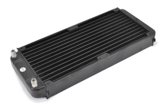
Realizzato interamente in alluminio, questo radiatore ad acqua è indicato per essere utilizzato in abbinamento a due ventole di raffreddamento 120x120 mm. Attacchi per tubo in gomma con diametro interno da 8 mm. Dimensioni massime (mm): 273x118x30.
